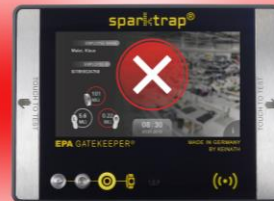
Rote Signalisierung bei „schlecht“ Messung
